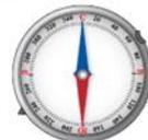
Стрелка компаса обозначенным концом (обычно синим цветом, формой или светящейся в темноте точкой) всегда показывает на север. Нужно установить компас горизонтально, дать стрелке остановиться, затем совместить ее обозначенный (северный) конец с буквой С (север) на корпусе. Теперь компас сориентирован.
